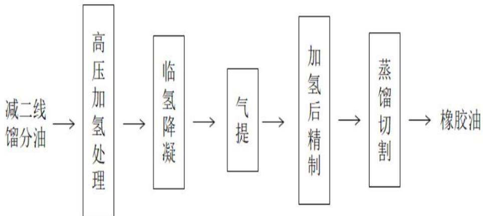
图：环保橡胶油工艺流程图
